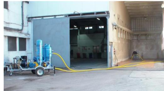
**Limpieza foso de Elevador y Vaciado de silos de trigo 25 Hp**
